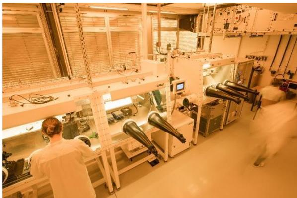
**Figura 14:** AQDL ospita una grande cappa ad aria controllata per il trattamento di campioni sensibili in atmosfera di azoto. I metodi che sono regolarmente disponibili all'interno di un'atmosfera protetta includono microscopia ottica, microscopia AFM, spin-coating, cottura o riscaldamento su piastra e deposizione di sottili film metallici mediante evaporazione a fascio elettronico..
