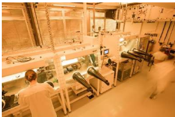
Slika 14: AQDL gosti veliko hermetično škatlo brez zraka za obdelavo občutljivih vzorcev v dušikovi atmosferi. Metode, ki so redno na voljo znotraj zaščitne atmosfere, vključujejo optično mikroskopijo, AFM mikroskopijo, spin-coating, pečenje ali segrevanje na vročih ploščah ter nanosene tanke kovinske filme z evaporacijo z elektronskim žarkom.
