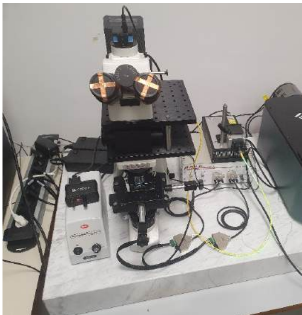
Slika 29: Aparat za Ramanovo mikroskopijo in spektroskopijo, ki je na voljo na UNG. Na desni strani je spektrometer Princeton Teledyne IsoPlane.
