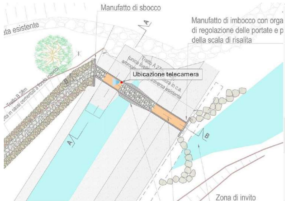
Figura 11: Posizionamento della telecamera nella scala di risalita.
