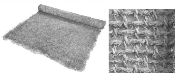
Figura 6: Esempio di geosintetico - geogriglia (ISO 18228-8:2019).
