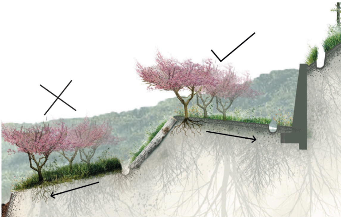
Shema 2: Prečni padec teras (Studio Podobarna)
