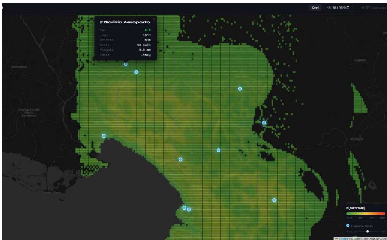
Slika 13 – Raven »Karst Fire Risk« na platformi, ki prikazuje dnevni zemljevid verjetnosti izbruha gozdnih požarov, ki ga je ustvaril model strojnega učenja na mreži s približno 40.000 točkami. Kazalniki meteoroloških postaj (modre točke) prikazujejo meteorološke podatke v realnem času v pojavnih oknih, vključno z FWI, temperaturo, vlažnostjo, hitrostjo vetra in padavinami.
