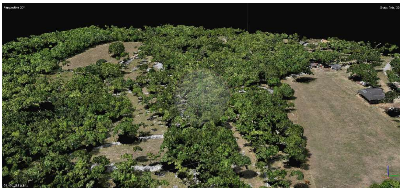
Slika 6 – Primer oblaka točk, pridobljenega iz slik, posnetih z optično kamero in fotogrametrično obdelanih za območje Nove vasi (poletno obdobje).
