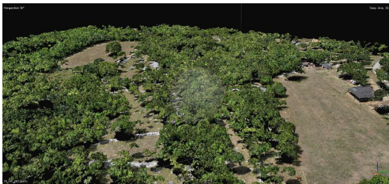
Figura 6 - Esempio di nuvola di punti ricavata da immagini acquisite con una fotocamera ottica ed elaborate fotogrammetricamente per l'area di Nova vas (periodo estivo).
