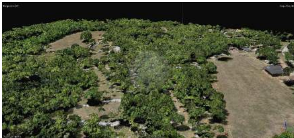
Figura 5 - Esempio di una nuvola di punti ricavata da immagini scattate con una fotocamera ottica standard per l'area di Nova vas in estate.
