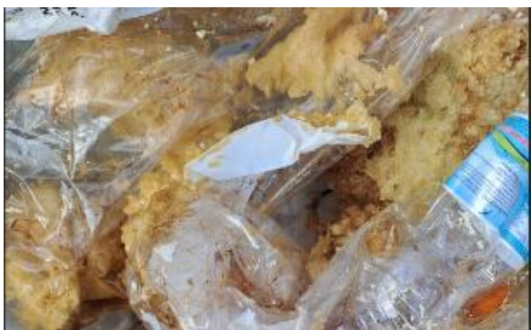
NEPRAVILNO POLIMERIZIRANI POLIMERI
