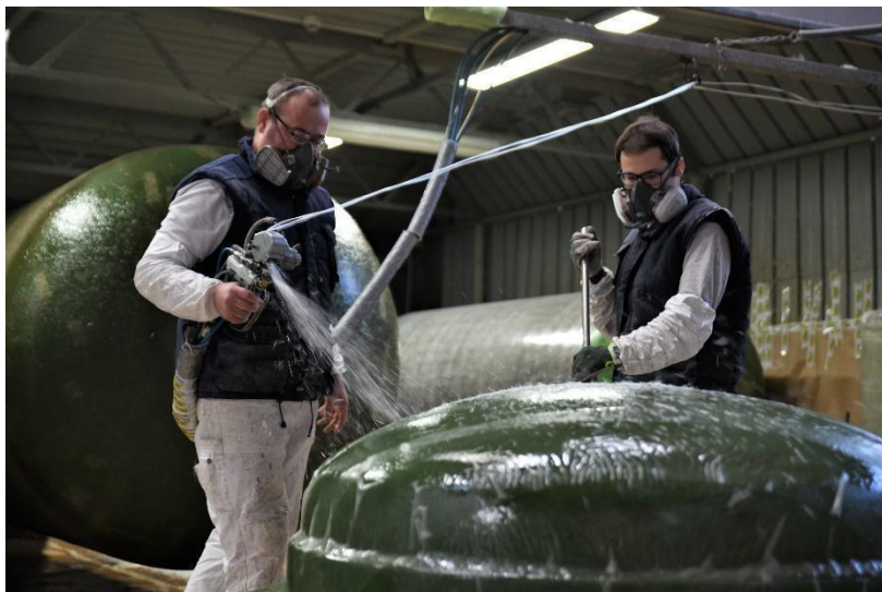
Figura 2c: Chopper gun lay-up (fonte: documentazione fotografica interna TECHNOL)
