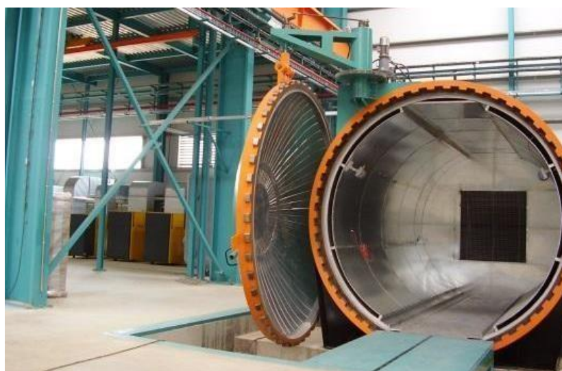
Slika 4: Primer konfiguracije oblikovanja v avtoklavu (vir: JaviRD na Wikimedia Commons).
