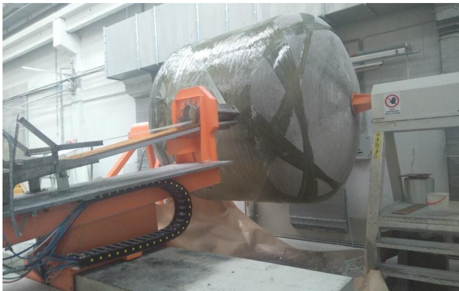
Figura 5b: Immagine esemplificativa di avvolgimento a filamento da pultrusione nella produzione di CFR (Fonte: documentazione fotografica interna TECHNOL).
