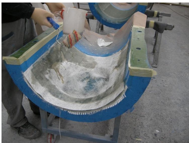
Figura 2b: una foto del processo di laminazione a mano all'inizio della produzione di CFR (fonte: documentazione fotografica interna TECHNOL)
