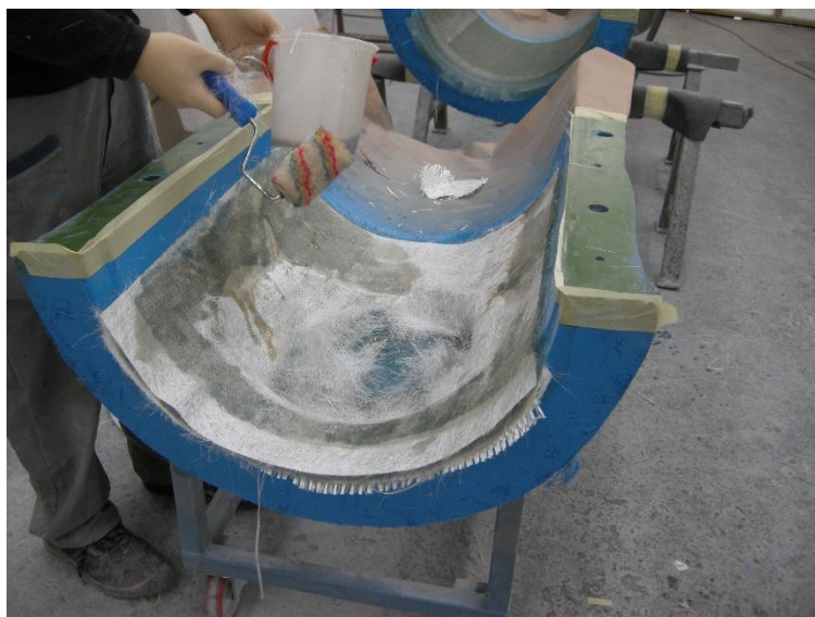
Slika 2b: fotografija postopka ročnega valjanja na začetku proizvodnje FRC (vir: notranja fotografska dokumentacija družbe TECHNOL)
