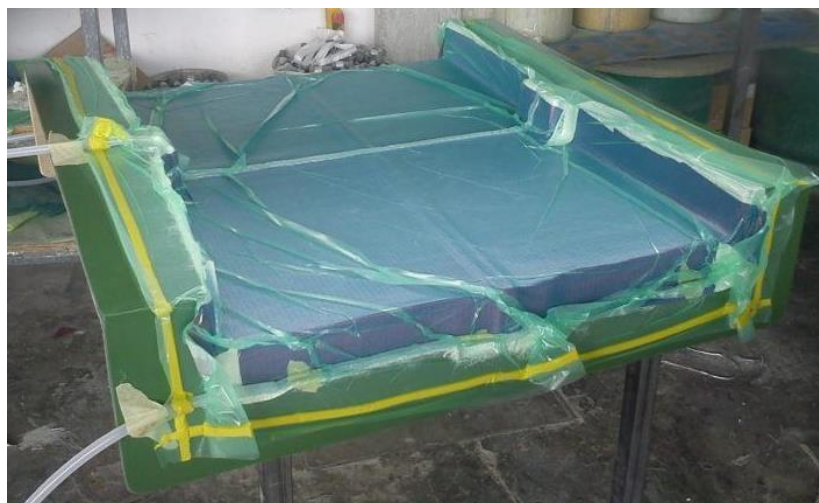
Slika 3b: Priprava navadne plošče FRC z vakuumskim vrečkanjem (vir: notranja fotodokumentacija podjetja TECHNOL).
