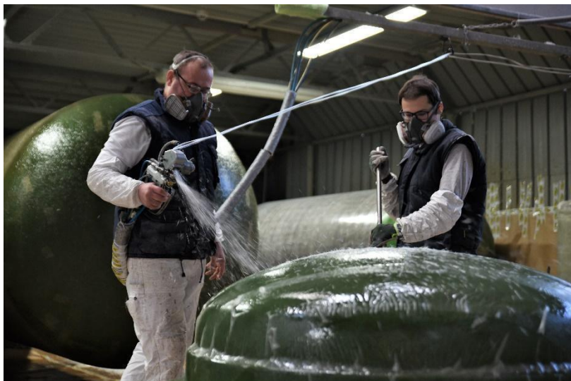
Slika 2c: Postavitev pištole Chopper (vir: notranja fotografska dokumentacija družbe TECHNOL)
