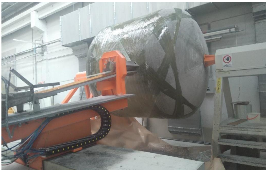
Slika 5b: Primer slike navijanja filamentov s pultruzijo v proizvodnji FRC (Vir: notranja fotodokumentacija podjetja TECHNOL).
