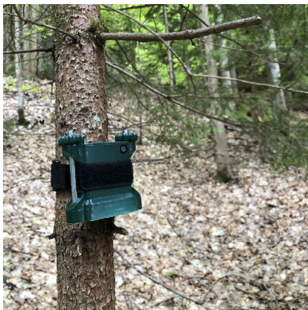
Figura 3. Unità di registrazione autonoma con dispositivo AudioMoth per il monitoraggio acustico passivo dell'allocco degli Urali. / Slika 3. Avtonomna snemalna enota z napravo AudioMoth za pasivni akustični monitoringa kozače. (Foto: Matjaž Bedjanič)
