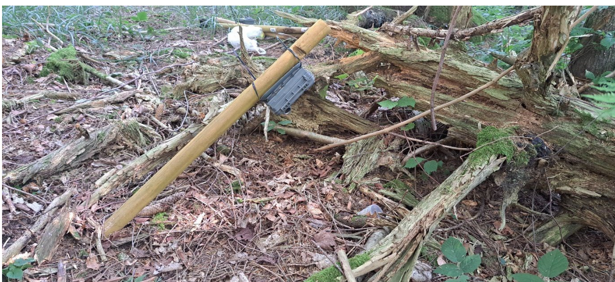
Figura 6. Trappola fotografica con telecamera su un palo puntata verso l'esca nel tubo sul terreno. / Slika 6. Foto-past s kamero na palici, usmerjena v vabo v lončku na tleh. (Foto: Al Vrezec)
