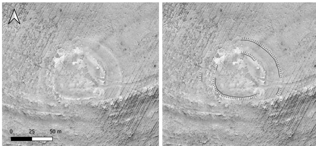
Figura 32 – Visualizzazioni e interpretazione del DMT ottenuto da LiDAR del castelliere di Trstelj (VAT al 60% di trasparenza in combinazione con LRM). Linee nere: resti di muri difensivi/terrazzamenti protostorici.
