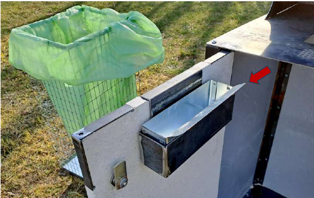
Deflettore per isolamento del sacco dal posacenere estraibile (interno)
